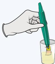
3. Prepara una disolución de bicarbonato de sodio. Coloca un poco de bicarbonato de sodio en otro vaso de medición y a continuación añade un poco de agua. Remueve bien la disolución.
