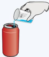
7. Echa la disolución de sulfato de cobre con sal disuelta dentro de la lata, y asegúrate de que la disolución cubrió el surco que hiciste.
